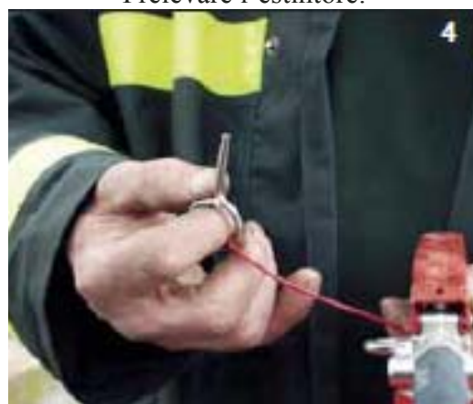
4 Estrarre e sbloccare la leva di intercettazione della spina di sicurezza
